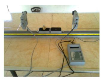
con las incertidumbres correspondientes. Luego se le agrega una pesita al carrito con vástago y se vuelve a realizar el procedimiento. Ídem hasta que se acaben las pesitas.
