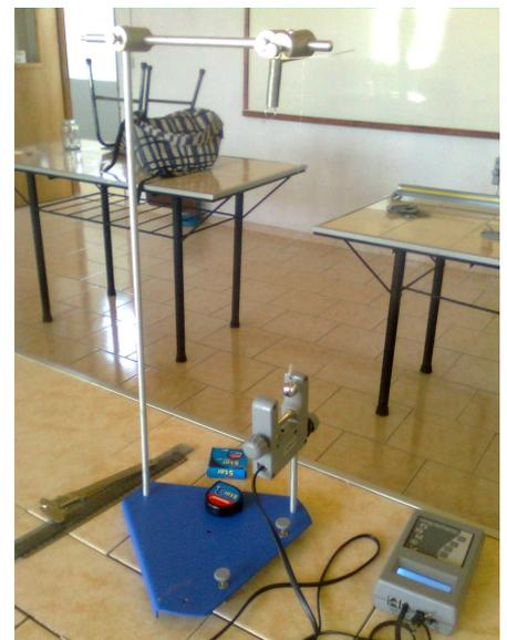
**MATERIALES:** soporte, cronómetro con barrera óptica, hilo, bolita metálica, cinta métrica, calibre.
